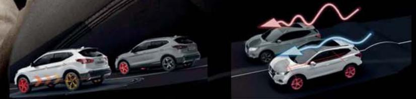
**SYSTÈME 4x4 INTELLIGENT.** En tout-terrain ou sur route, la technologie 4x4 du nouveau QASHQAI maximise l'adhérence des pneus. À l'aide d'un ordinateur et de capteurs, ce système intelligent mesure le patinage des roues et distribue instantanément jusqu'à 50 % du couple aux roues arrière.
